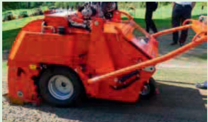
**Abb. 6:** Der Wiedenmann Core Recycler sammelt Bodenkerne auf und trennt über Trommelsiebe den Rasenfilz vom Tragschichtmaterial.
