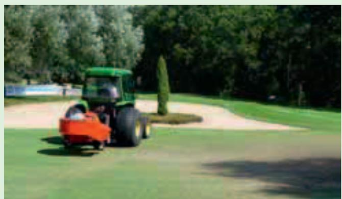
**Abb. 10:** Das Säubern einer Rasenfläche mit dem leistungsstarken Wiedenmann-Gebläse Mega Twister erfolgt rasch und intensiv, selbst Sand lässt sich in die Aerifizierlöcher einblasen.
