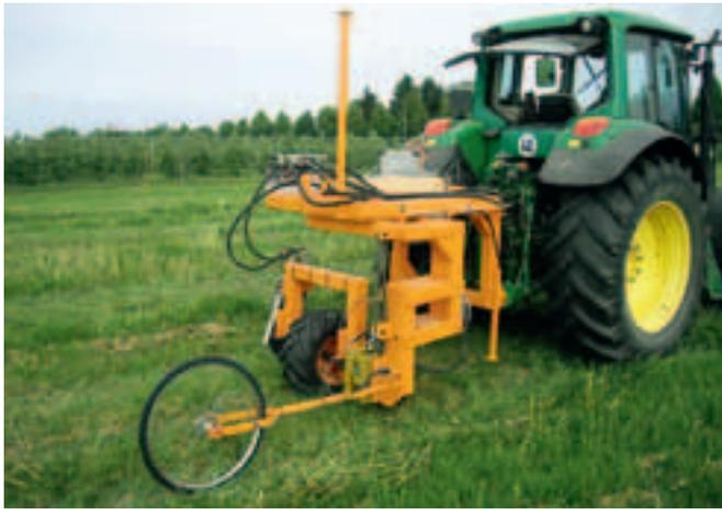
Abb. 1: Mobile Einzelradmesseinrichtung bei Messfahrt mit AS-Profilrad. (Foto: Morhard)
