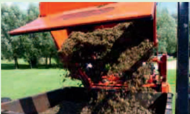
**Abb. 7:** Die Entleerung des Sammelbehälters beim Wiedenmann Core Recycler erfolgt als Hochentleerung direkt auf das bereitgestellte Transportfahrzeug.
