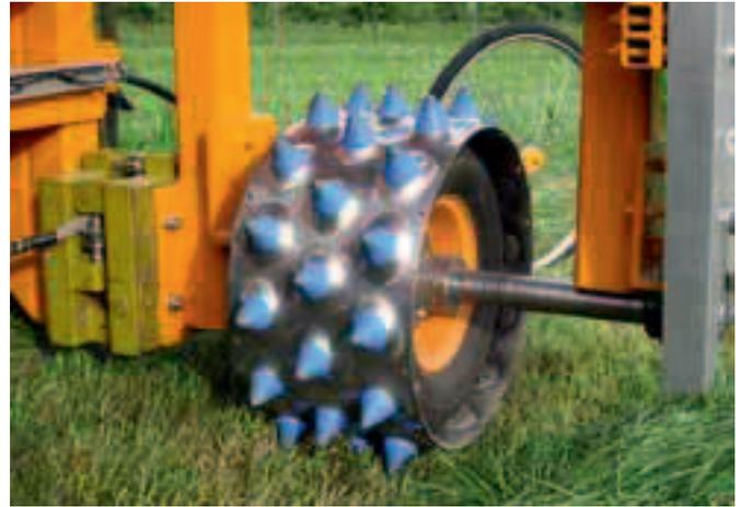
Abb. 2: Stachelwalze in mobiler Einzelradmesseinrichtung auf Grasstoppel. (Foto: Morhard)
