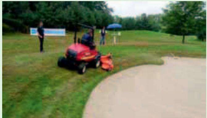
**Abb. 4:** Gerade im Semi-Rough Bereich an Bunkerrändern bieten die schwenkbaren Seitenteile des Mähdecks „RMR 230 V“ eine gute Anpassungsmöglichkeit.
