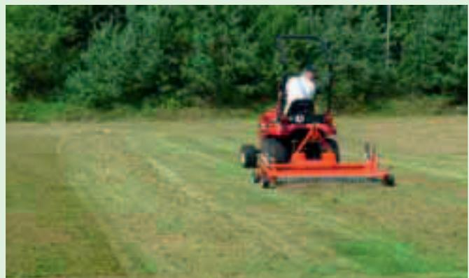
**Abb. 8:** Mit dem Terra Rake Rasenstriegel lassen sich problemlos abgestorbene Pflanzenteile aus der Rasennarbe entfernen.
